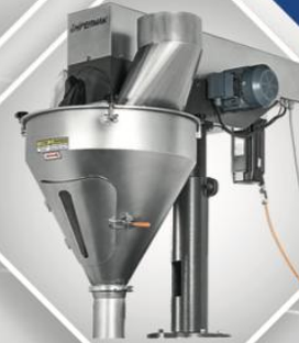
VİDALI DOLUM ÜNİTESİ AUGER FILLING
