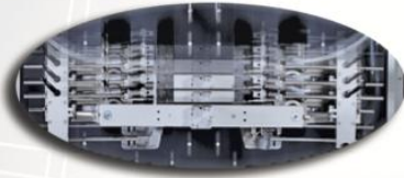
SÜREKLİ HAREKETLİ ÇENE SİSTEMİ CONTINUOUS MOTION SEALING SYSTEM
